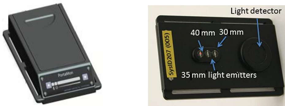
Figure 26. La spectroscopie du proche infrarouge (NIRS) (Portamon, Artinis, Medical System, Zetten, Pays-Bas)
