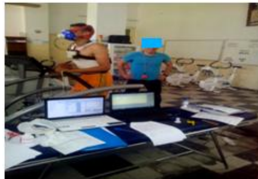
Figure 27. Mesure des échanges gazeux respiratoires à l'aide d'un analyseur de gaz portable (COSMED K4b2, Rome, Italie)
