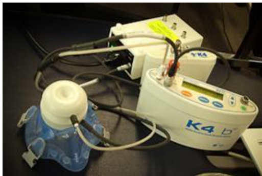
Figure 27. Mesure des échanges gazeux respiratoires à l'aide d'un analyseur de gaz portable (COSMED K4b2, Rome, Italie)
