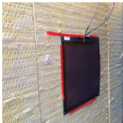
Fluxmètre positionné sur la paroi
