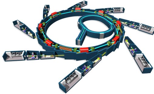
FIG. 1.11 – Schéma d'un synchrotron. Les paquets d'électrons dans l'anneau de stockage sont accélérés linéairement par portions (gain en énergie) et déviés périodiquement par de puissants électroaimants (en rouge), ce qui a pour effet de produire du rayonnement X dans la direction de propagation des électrons. Des stations expérimentales sont installées en face de chaque ligne de lumière pour utiliser le rayonnement X produit.
