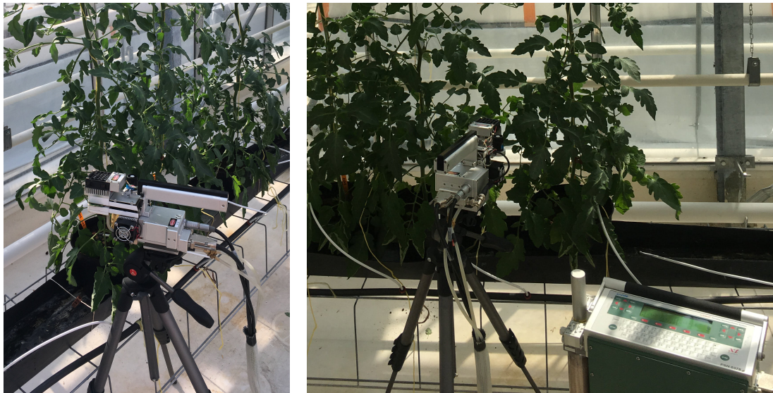
Figure 1.7 : Système portable LI-6400XT positionné sur la foliole terminale d'une feuille de tomate en serre à Avignon.
