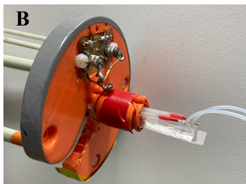
Figure 1.21 : (A) Représentation schématique de la puce de micro-fluidique utilisée pour valider les méthodes IRM. (B) Installation de la puce de micro-fluidique dans l'antenne selle de cheval de 14 mm de diamètre dédiée aux études sur la tige de tomate. (C) Photo de l'installation avec la balance de précision à gauche et le contrôleur de micro-fluidique à droite.
