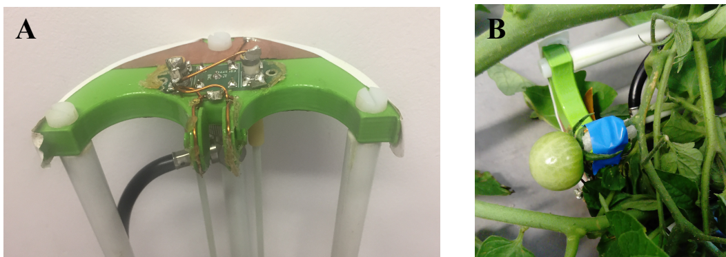
Figure 1.26 : (A) Antenne pédicelle de type Helmholtz conçue pour faire des acquisitions à l'échelle du pédicelle de tomate ou à l'entrée du bouquet. (B) Installation d'un pédicelle de tomate WVA106 dans l'antenne pédicelle.
