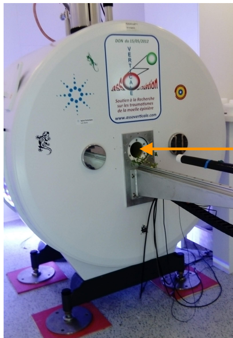
Figure 1.4 : Configuration expérimentale de l'aimant supraconducteur horizontal 9,4T du scanner IRM Agilent utilisé dans ce travail de thèse.
