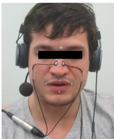
**Figure 66.** Accéléromètre piézoélectrique installé sur le nez d'un locuteur : les deux pastilles captant les vibrations sont fixées sur chaque côté du nez du locuteur avec un adhésif double face. Cette figure montre également la fixation du micro serre-tête, et celle des capteurs labiaux et frontal.
