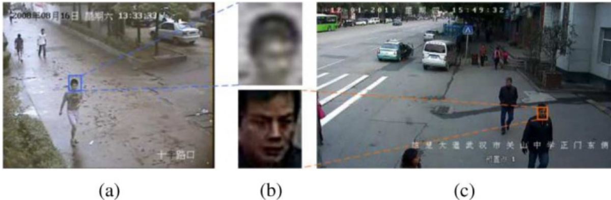
Figure 1.6: systèmes typiques de vidéos de surveillance. (a) et (c) sont les images de surveillance d'une caméra de taille CIF (pixels) et d'une caméra de taille 720P (pixels) respectivement; (b) montre deux faces intéressées bruyantes extraites de (a) et (c) [17].
