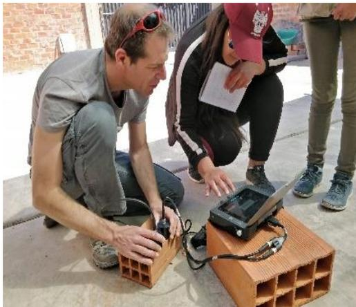
Mesure Brique isolé le pundit
