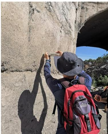
Mesure de pont 8 octobre par le scléromètre.
