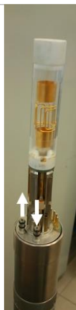
Figure 19 : Photo de la bobine sur la sonde de diffusion sans le gradient de champ avec les connectiques du circuit d'eau.
