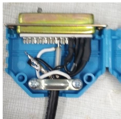
Figure 22 : Photo de l'intérieur d'un DB25.
