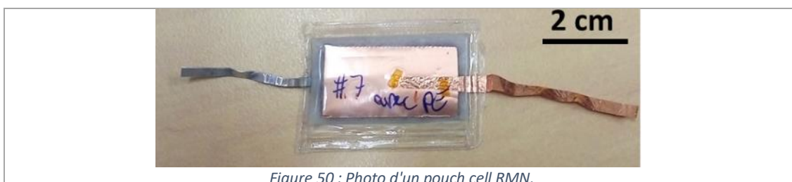
Figure 50 : Photo d'un pouch cell RMN.
