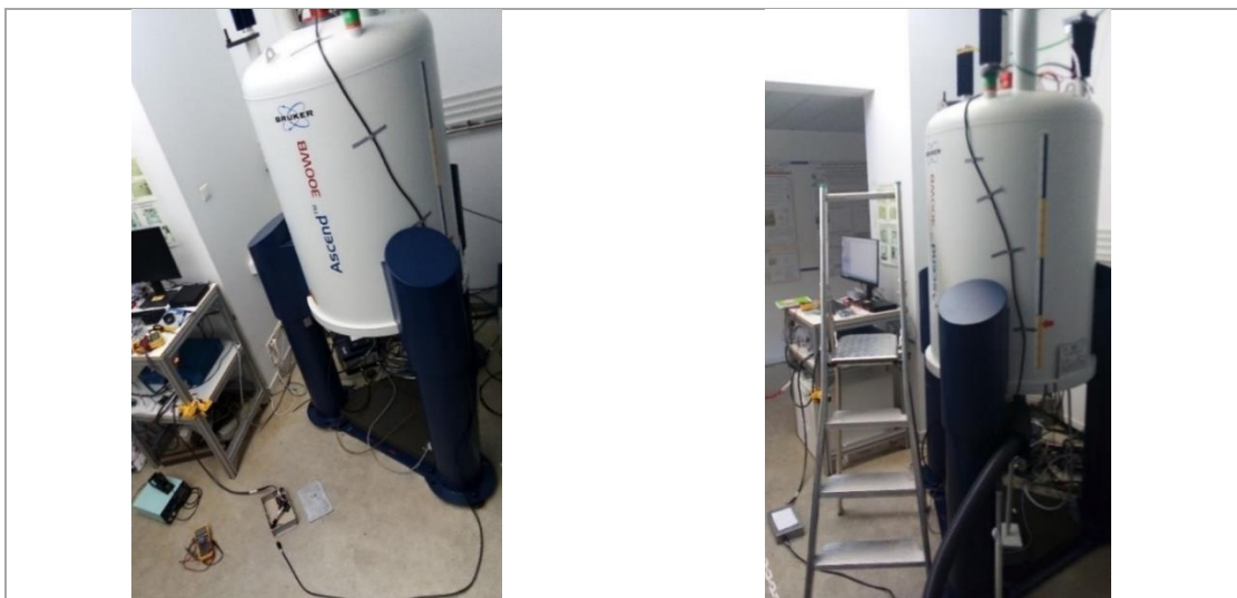
Figure 16 : Photos du spectromètre avec le câble in situ positionné pour optimiser le niveau de bruit des spectres.
