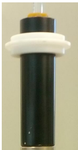
Figure 12 : Photo de l'insert du gradient de champ diff30.
