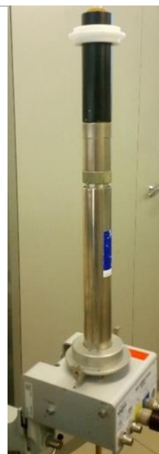
Figure 20 : Sonde de diffusion avec fourreau de gradient.
