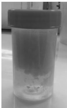
Figure 67 : Photo de l'hydrolysat des graisses de canard à température ambiante
