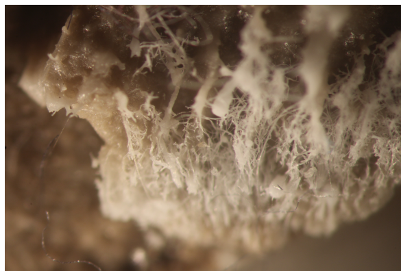
FIGURE A.16 – Observation au microscope optique (x10) d'un échantillon de FSPC fritté par à 1600 °C sur la zone fondue en surface
