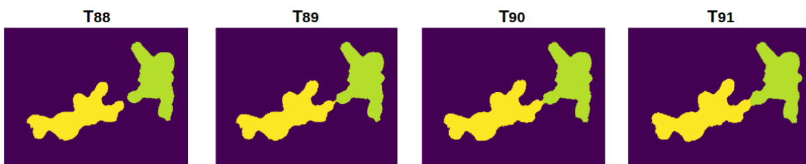
FIGURE 5.13 – Résultats de la correction de labellisation des pixels (objets aux temps T_{88} , T_{89} , T_{90} et T_{91} ) par l'algorithme de Watershed dans le cas de la segmentation des champignons initialement numérotés 8 et 9.
