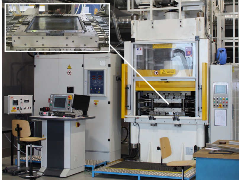
Figure 2.4 – Vue d'ensemble du pilote de thermocompression EDyCO et vue rapprochée du moule de 400 \times 400 \text{ mm}^2
