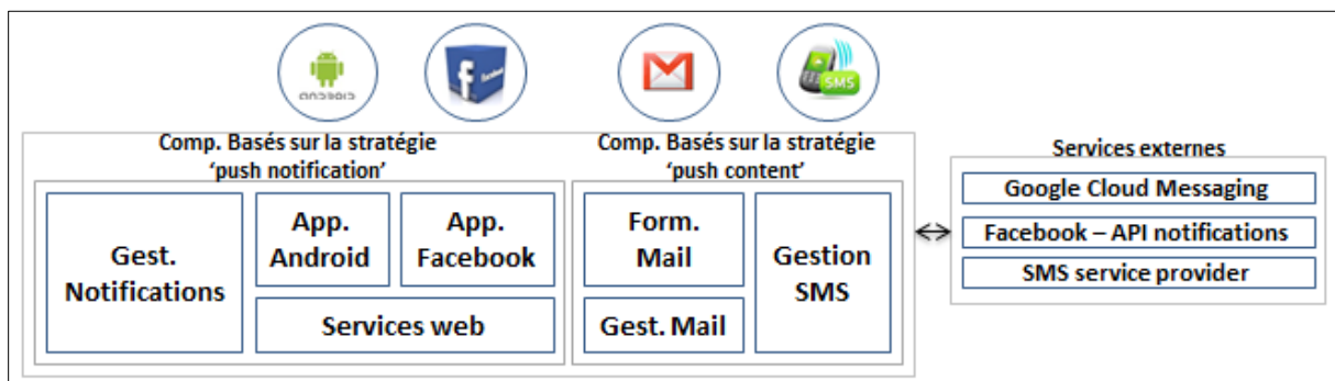
Figure 37. Composants de la couche Interface
