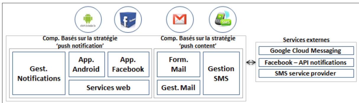
Figure 37. Composants de la couche Interface
