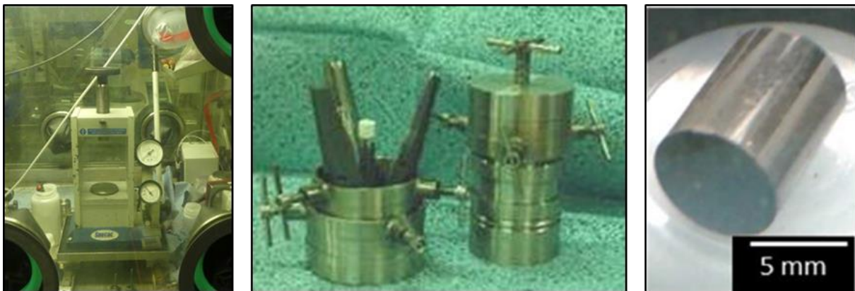
Figure 40. Photographie de la presse manuelle SPECAC en BâG au L7. Photographie d'un moule tricoquille au centre avec en blanc une pastille d'alumine en BâG au L7. Photographie d'une pastille du lot G-15 issue de la thèse de La Lumia [Lalu19].
