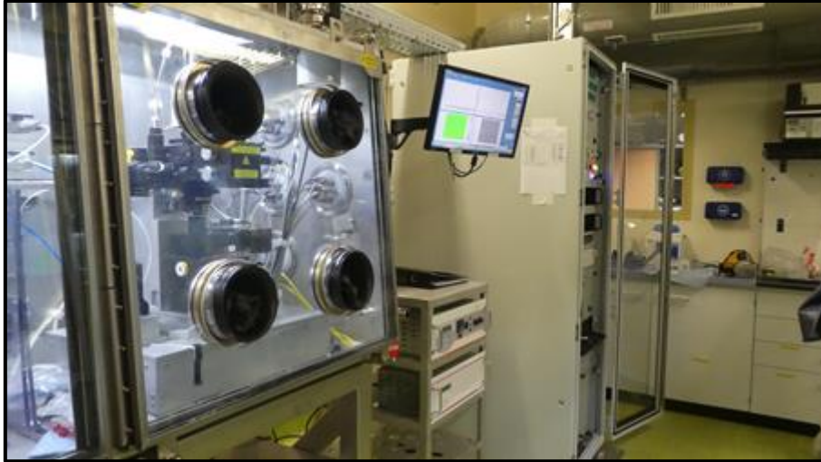
Figure 57. Photo de la BàG Raman (à gauche) et de sa baie de contrôle (à droite) au L26.
