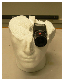
FIGURE 2.34 – Photo de la caméra montée dans la tête d’un mannequin à l’emplacement de l’œil gauche. (Extrait de [Gilson 2008])
