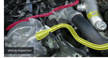
FIGURE 1.21 – Affichage synthétique pour la réalisation de tâches de maintenance en environnement statique.
