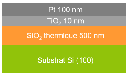
FIGURE 4.24 – Empilement utilisé pour étudier la croissance de LiNbO 3 sur électrode de platine.
