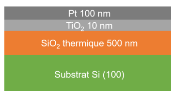
FIGURE 2.30 – Empilement utilisé pour l'étude de la piézoélectricité de la couche de \text{LiNbO}_3 déposée à température ambiante puis recuite à 600^\circ\text{C} .
