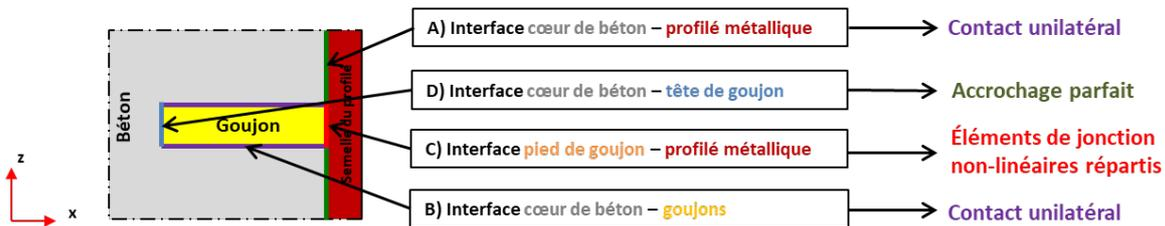
Figure 2-55 Conditions de liaison de la modélisation de l'essai push-out avec des éléments de jonction en interface goujons - plaque
