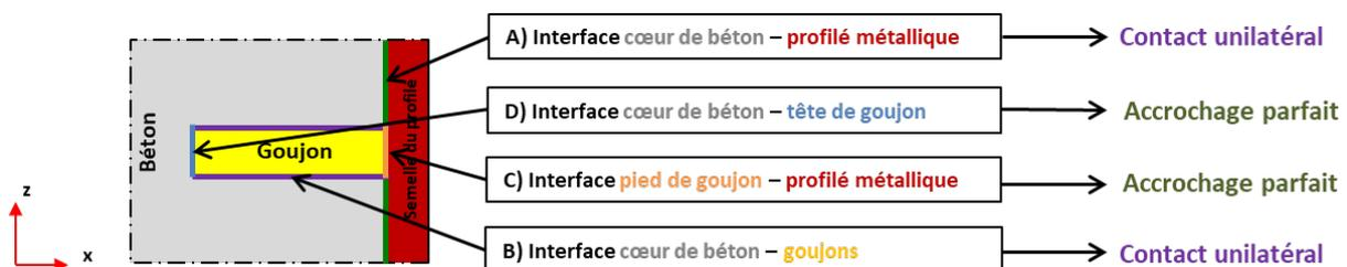
Figure 2-12 Conditions de liaison de la modélisation de l'essai push-out
