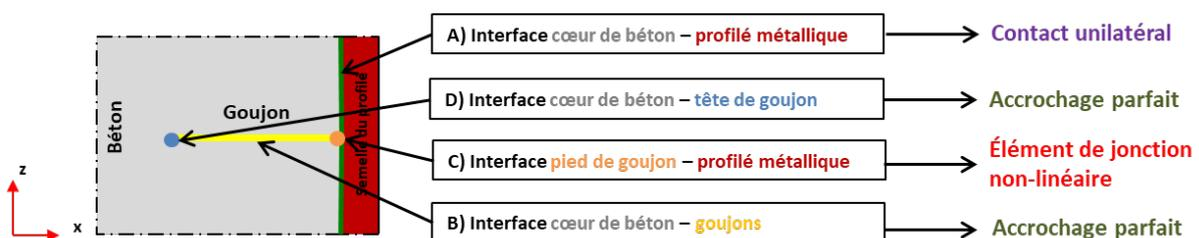
Figure 3-35 Conditions de liaison de la modélisation avec connecteurs 1D de l'essai push-out
