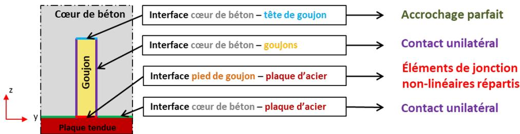
Figure 3-9 Conditions de liaison de la modélisation des poutres SPI
