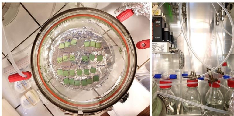
Figure 22: photographie des coupons de cuivre traités et rangés dans le dessiccateur avec système de réglage du flux d'air humide, réglé à 60% d'HR
