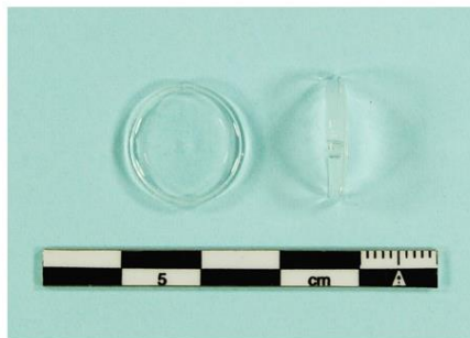
Figure 48: photographie des monolithes de TMOS, de face et de profil
