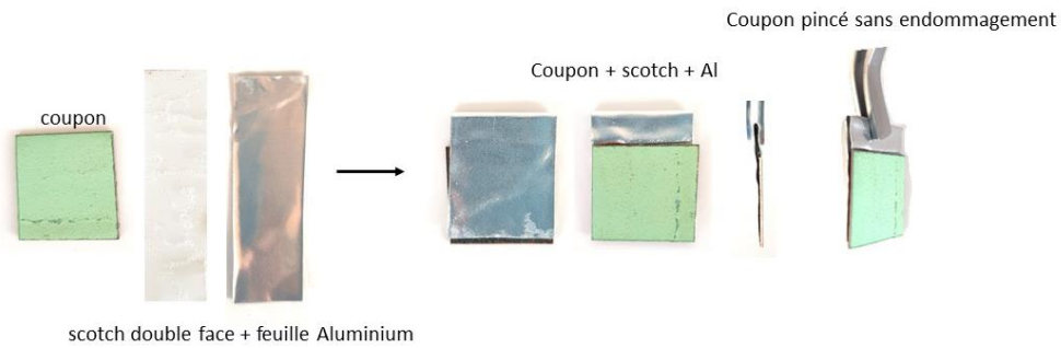
Figure 19: photographie d'un coupon préparé pour le dip-coating, avec système d'attache pour le pincage du coupon sans endommagement de la surface
