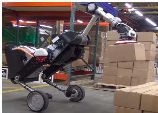
FIGURE 1.5: Un exemple de manipulateur mobile hybride, le robot HANDLE [16].
