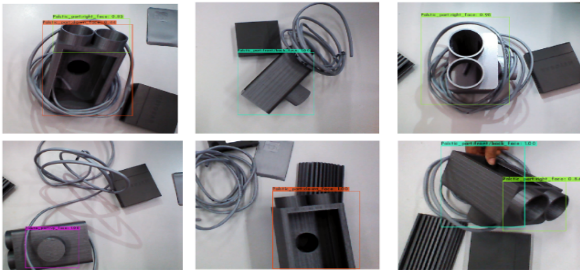
FIGURE 3.16: Résultats de classification des face géométriques (YOLO-V4)
