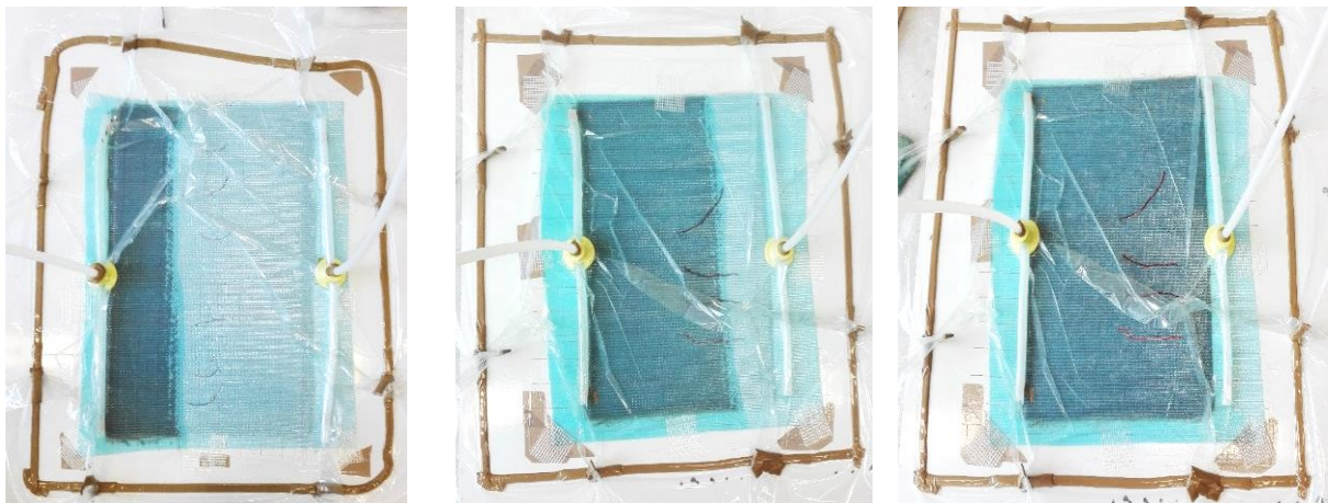
Figure 2. 6. Différentes phases d'infusion (avancement de la résine)
