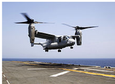
FIGURE 1.13 – Véhicule à rotor convertible pouvant passer d'un mode de décollage vertical à un mode à voilure fixe
