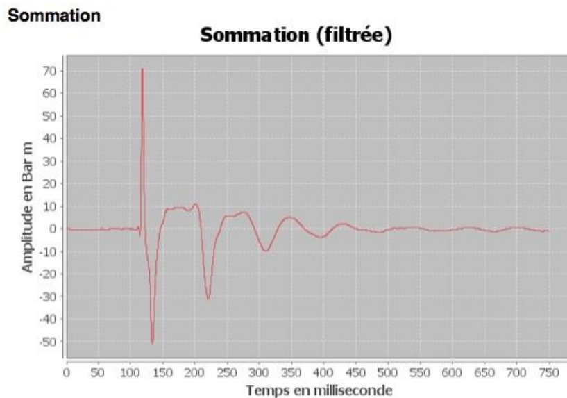
Figure 6 : Signal théorique de la source MARGATS (far field) filtré
