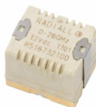
Figure I-13 : Le relais électromécanique R516 commercialisé par la société Radiall.
