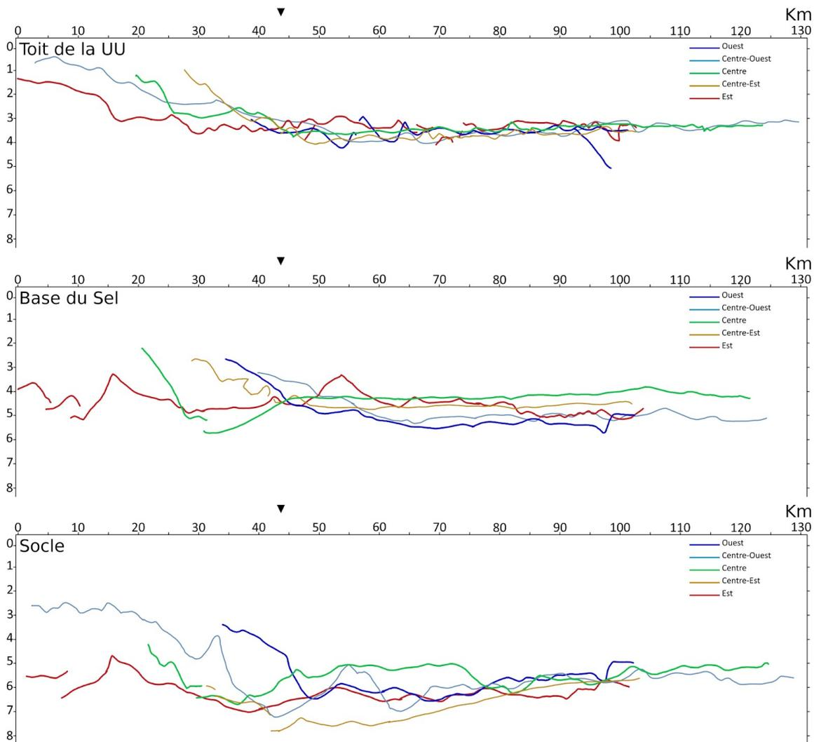
**Figure 6-3 :** Horizons du Toit du Socle (haut), de la Base du Sel (milieu) et du toit du Socle (bas) des lignes sismiques types de chaque zone (lignes 1 à 6 de l'article). Les graduations sont en kilomètres, avec une exagération verticale de  $\times 4$ . Les profils ont été alignés sur la transition océan/continent, matérialisée par une flèche noire.
