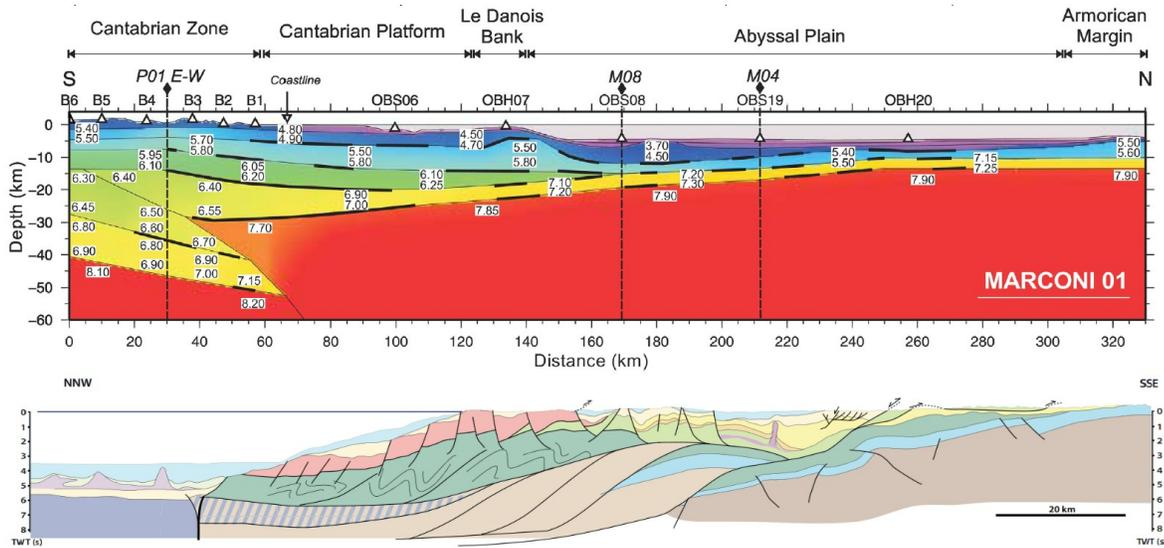
**Figure 6-11 :** Comparaison entre un modèle de vitesse de la marge cantabrique (Ruiz et al., 2017) et une coupe terre-mer en temps double de la marge algérienne (Leprêtre et al., 2018, cf **figure 2-8** pour la légende). Sur les deux profils, on constate que la marge, à la faveur de structures de la croûte, a développé une faille à pendage vers l’océan
