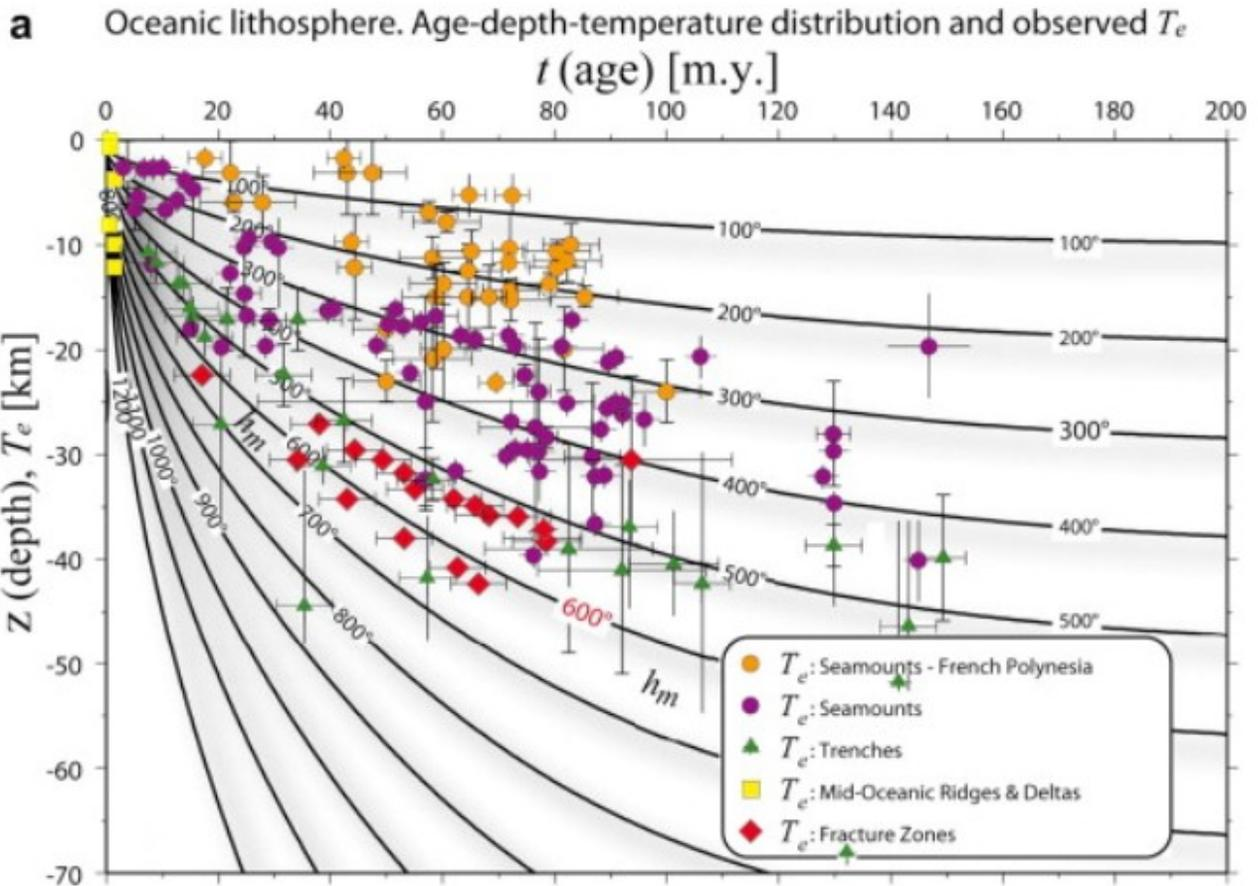
**Figure 1-1 :** Corrélation entre l'épaisseur élastique ( $T_e$ ) et le rapport age/température de la lithosphère océanique, d'après Burov (2011).  $T_e$  augmente en fonction de l'âge thermique de la lithosphère océanique, ce qui rend la flexion de celle-ci de plus en plus difficile. Cette augmentation est particulièrement rapide dans les premiers millions d'années, avec un isotherme  $500^\circ\text{C}$  qui passe de quelques kilomètres de profondeur à près de 20 km en 20 Ma.
