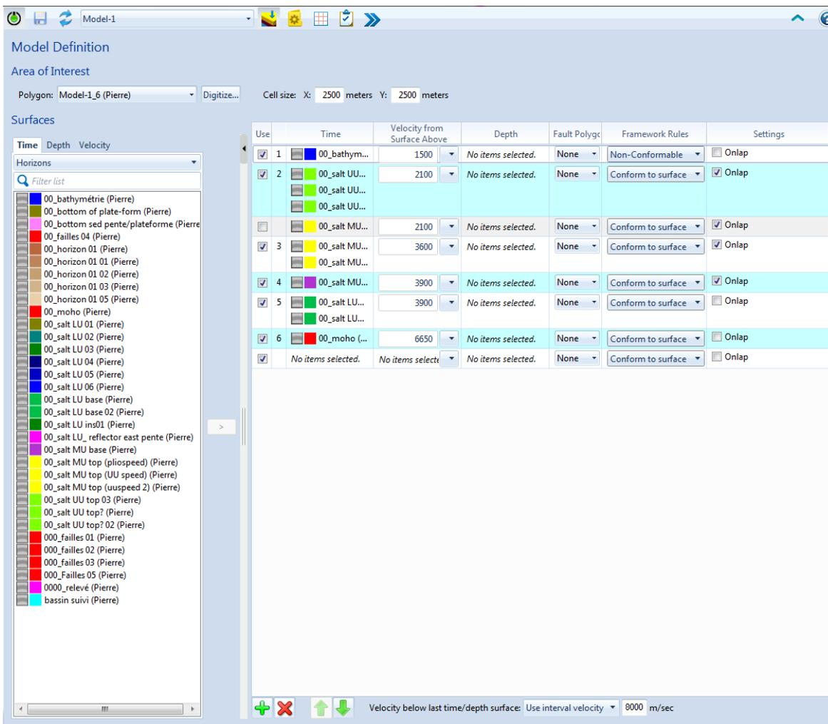
**Figure 4-7 :** Interface de conversion en profondeur de Kingdom Suite© seismic and geological interpretation software 2015. Dans la colonne de gauche se trouve la liste des horizons disponibles. Dans la colonnes de droite, les horizons sélectionnés comme repères et la vitesse qui leur est attribuée.
