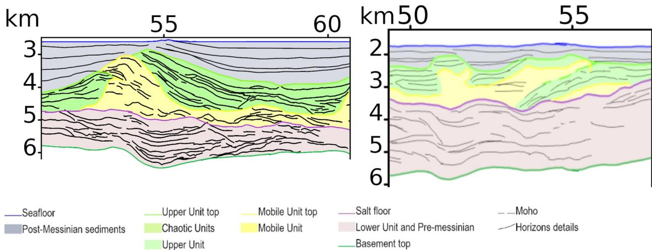
**Figure 4-1 :** Structures sismiques liées au sel. (*gauche*) diapir déformant les horizons (*droite*) rampe dans le sel.
