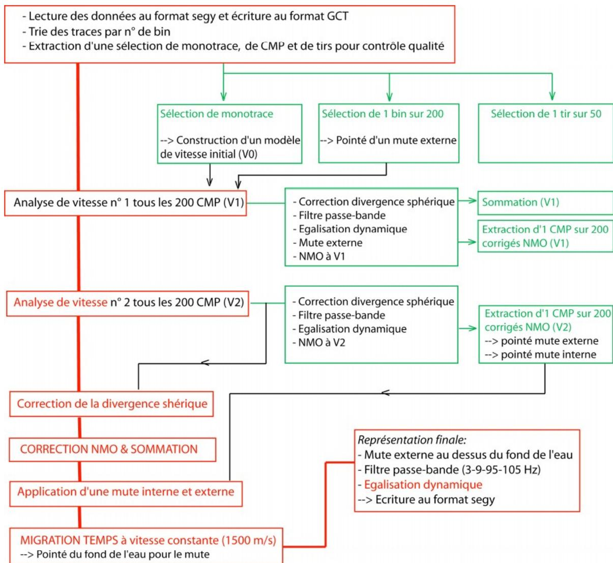
**Figure 3-2 :** Séquence de traitement initialement appliquée sur l'Atalante (logiciel geocluster). Les étapes encadrées en vert correspondent à du contrôle qualité ou à des étapes intermédiaires. Les étapes en rouge constituent le cœur du traitement. D'après Leprêtre (2012).
