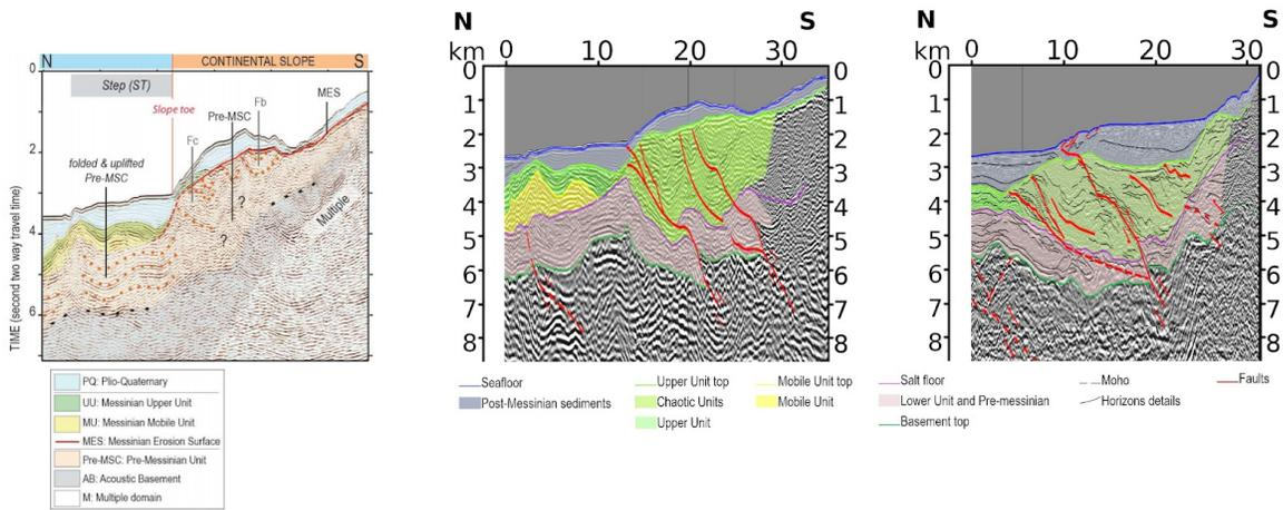
**Figure 4-9 :** Extraits de la section 6 de l'article (section 5.1) située au large d'Annaba. A gauche, l'interprétation tirée de la bibliographie, en temps double, d'après Ara et al. (2015). Au milieu, l'interprétation présentée dans ce travail en profondeur (exagération verticale x5). En bas, un extrait d'une section similaire sur la marge centrale, en profondeur (exagération verticale x5), déjà identifiée comme une accumulation sédimentaire dans les travaux précédents.
