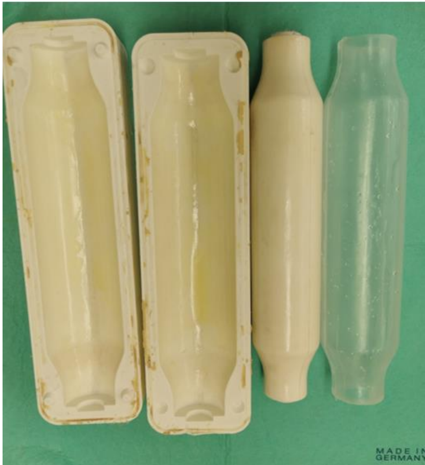
Figure 93 : moule utilisé pour la fabrication d'une chambre de compliance de 50 mm
