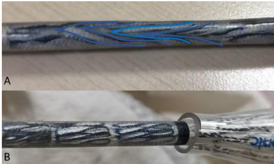
Figure 54 : aspect des stents contractés après la mise en cathéter
