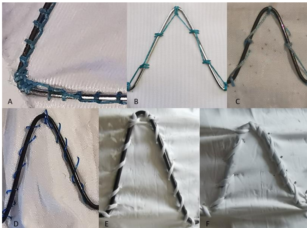
Figure 51 : Différentes fixations stent-membrane
