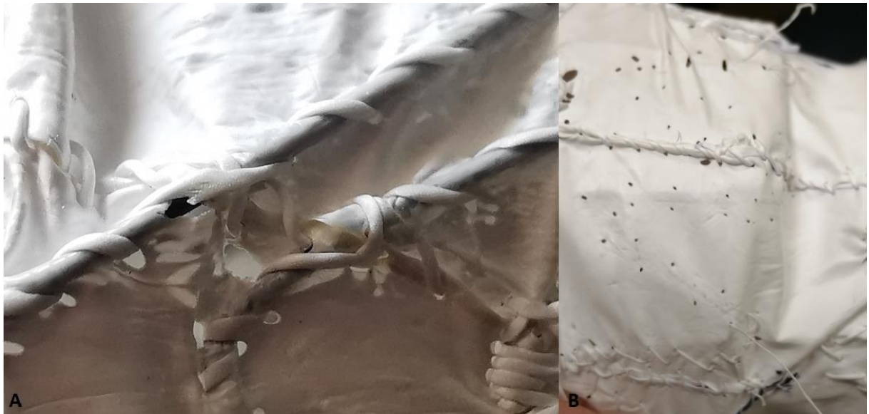
Figure 107 : détérioration structurelle des endoprothèses
