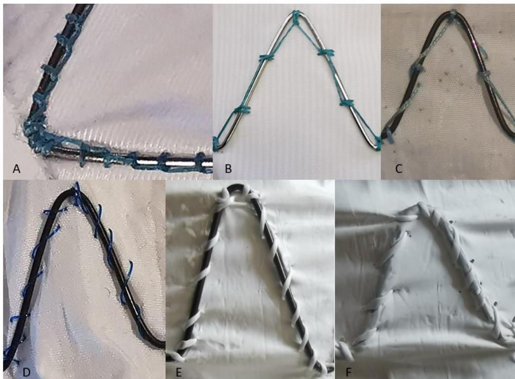
**Figure 51** : Différentes fixations stent-membrane
