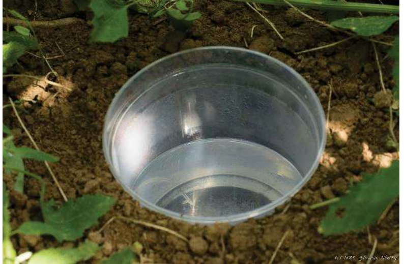
Photo 1 : Piffall : piège à invertébrés constitué d'un pot de prélèvement rempli de liquide
