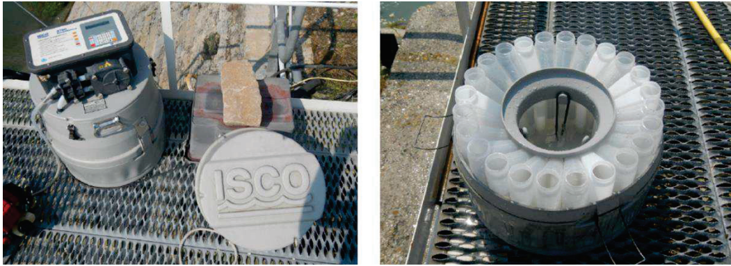
Figure 2 : Photos d'un échantillonneur automatique ISCO. Source: Launay (2014).
