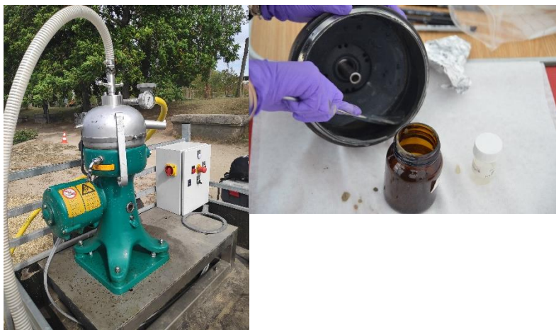
Figure 23: Photo de la centrifugeuse mobile et de la récupération des particules dans un flacon de verre brun.
