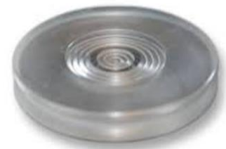
Figure 33: Illustration d'un support PMMA utilisé pour des échantillons d'environ 1 g. Source: Centre Henri Longchambon
