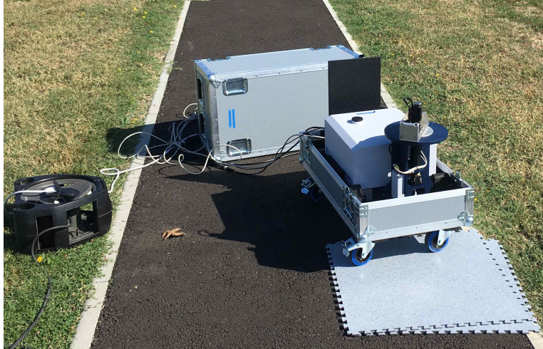
FIGURE 1.12 – Un EM27/SUN déployé lors de la campagne de mesures mutli-instruments MAGIC 2020.
