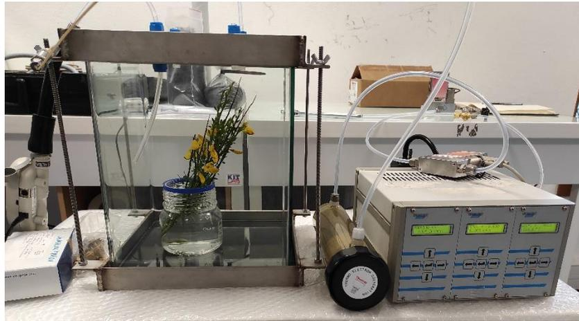
Figure V- 3 : Schéma du principe de mesure des COVB de la chambre de mesure BIO-PUY-GAZ et photo de la chambre en fonctionnement avec du genêt à baie en cours d'analyse.
