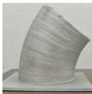
Figure 1.28 – Fabrication d'un huitième de tore (en aluminium) par une stratégie 3D de découpe suivant l'axe neutre avec variation d'avance du fil [Querard+2019].
