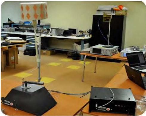
Figure A.5.10 – Banc de mesures du prototype de l'antenne réalisé [117]
