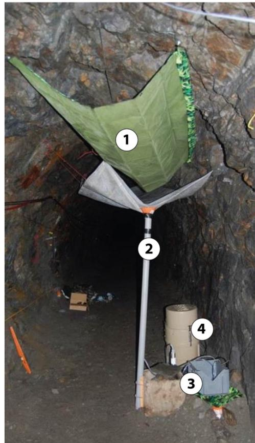
Figure 36: Dispositif en place aux exutoires G1 et G2 : 1. Bâche de récupération des eaux de ruissellement, 2. Collecte des eaux, 3. Bac de récupération des eaux (permet l'installation de sondes de mesures et prélèvements), 4. Instrumentation (préleveur automatique, sonde CTD, station mesure de débit).
