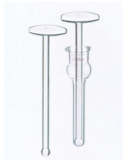
Figure 24 : Homogénéiseur Dounce constitué d'un cylindre et de 2 pistons (A et B)
