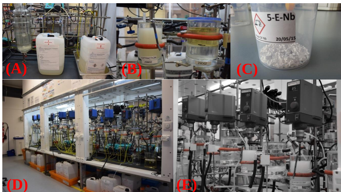
Figure 35. Photos prises lors du pilotage du procédé. (A) : bidons d'alimentation de solution issue du procédé voie sodique et solvant. (B) : Un étage de la batterie d'extraction ; mélangeur de 200 mL à gauche et décanteur de 400 mL à droite. (C) : Premier oxyde \text{Nb}_2\text{O}_5 \cdot n\text{H}_2\text{O} purifié à 99,5 % produit. (D) : sorbonne contenant les 10 étages (10 mélangeurs + 10 décanteurs) du procédé. (E) : batterie d'extraction.
