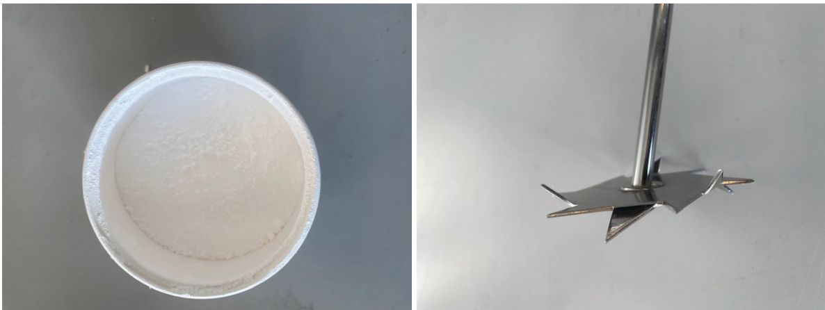
FIGURE 2.6 – Gauche : Carbopol 980 en poudre. Droite : Agitateur à pales pour éliminer les grumeaux lors la dissolution du carbopol en poudre dans l'eau.
