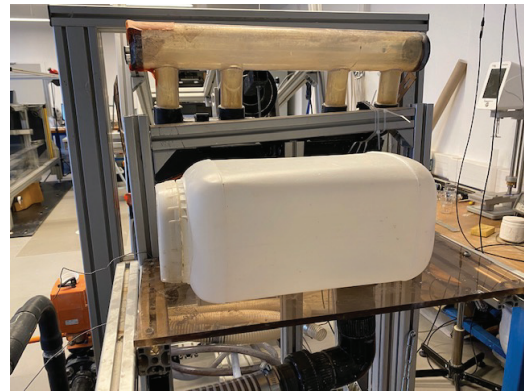
FIGURE 2.4 – Gauche : Transformée de Fourier d'un signal enregistré par le télémètre laser en absence de perturbation. Le cercle vert indique les vibrations liées à la pompe. Droite : Photo du bac tranquilisateur sous pression. Ce bac permet à l'aide de sa surface libre d'atténuer les pulsations de la pompe.
