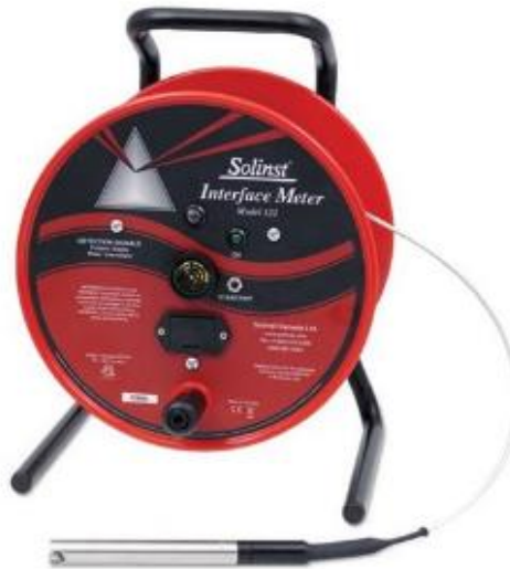
Figure 1 : Photo de la sonde interface Solinst utilisée dans le cadre du projet de recherche
