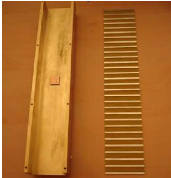
Figure I. 8: Antenne sectorielle de la famille de BIE planaire.
