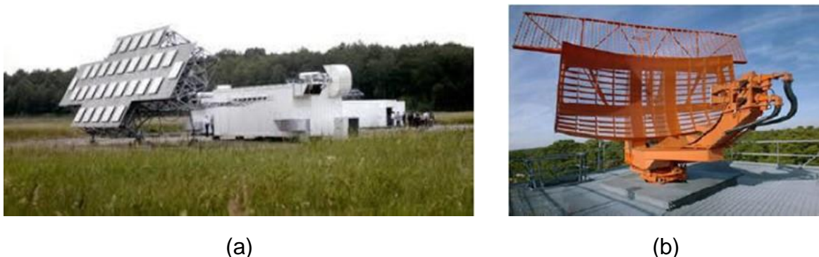
Figure I. 18: (a) Radar Grave français conçu pour détecter les satellites orbitant entre 400 et 1000 km (b) Radar primaire à balayage mécanique typique d'un aéroport.
