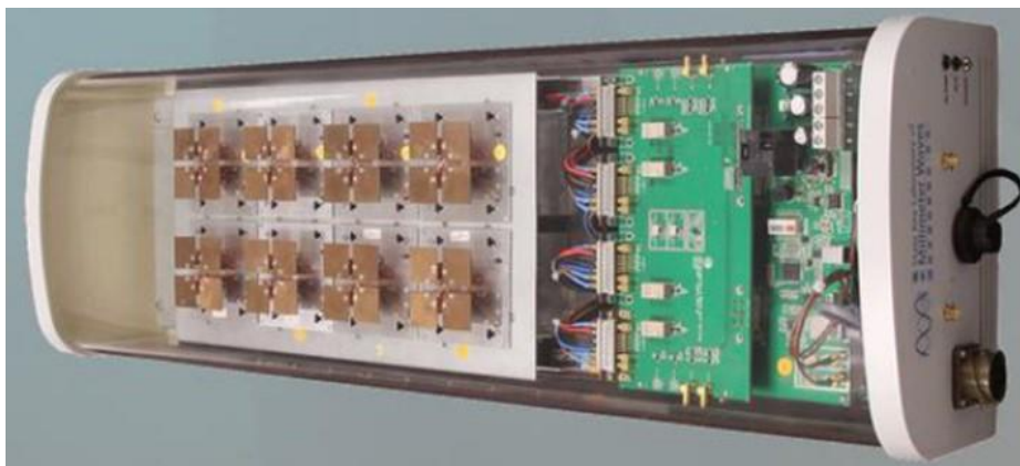
Figure I. 14: Antenne pour la 4G.
