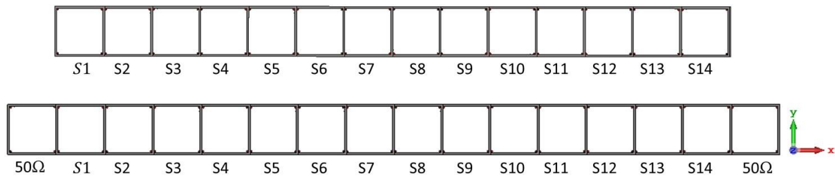
Figure IV. 19: MARPEM 1D 14 éléments + 2 pixels passifs à 50 Ω.
