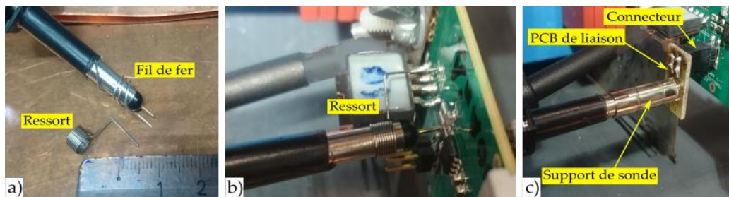
Figure 231 : a) Photo du ressort utilisé comme pointe de touche pour la masse, et de la connectique artisanale faite avec du fil de fer ; b) photo du ressort monté sur la sonde lors de la mesure ; c) photo de la sonde montée sur son support et reliée à la carte DUT à travers un PCB de liaison et un connecteur.
