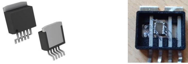
Figure 138 : à gauche : boîtier D2pak générique ; à droite : transistor du CEA dans son boîtier D2pak.
