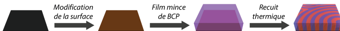
Figure 6. Représentation schématique du protocole de formation d'une structure auto-assemblée de PS- b -PMMA. 1) Modification de la surface du substrat en greffant un RCP ; 2) Déposition d'un film mince de BCP ; 3) Chauffage du film pour promouvoir l'auto-assemblage par déplacement des chaînes polymères.
