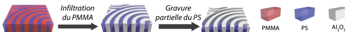
Figure 8. Représentation schématique du protocole de la modification d'une structure auto-assemblée pour l'empilement. 1) Infiltration du PMMA avec de l'alumine par SIS ; 2) Gravure du PS par plasma.
