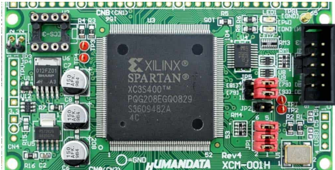
FIGURE 1.8 – Les FPGA sont de petites cartes programmables composées de semi-conducteurs qui ont la particularité d’effectuer des actions spécifiques de manière rapide et efficace grâce à leur système logique fermé et maîtrisé.
