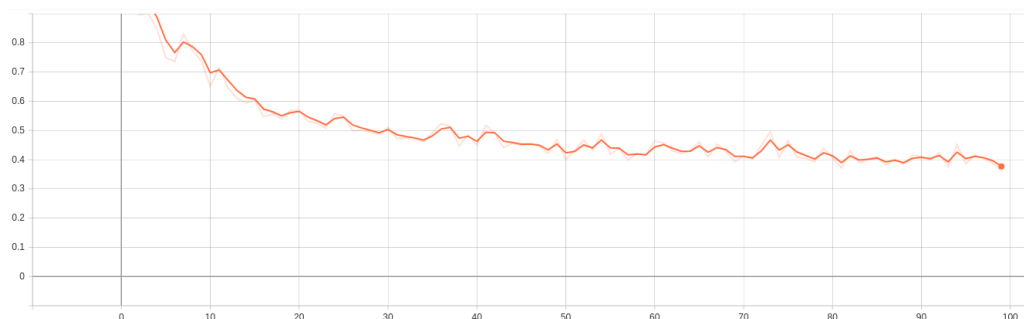
(A) Valeur de la fonction de coût du modèle (Ordonnée) sur la base de données d'entraînement en fonction du nombre d'epoch écoulé (Abscisse).
