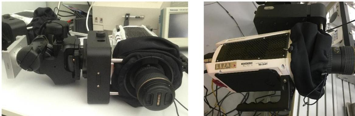
Figure II.15 : Caméra Phantom V711 et leurs Scheimpflugs
