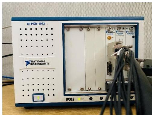
Figure II.8 : Centrale d'acquisition dynamique
