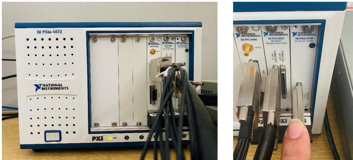
Figure II.23 : Centrale d'acquisition et carte de génération de signal
