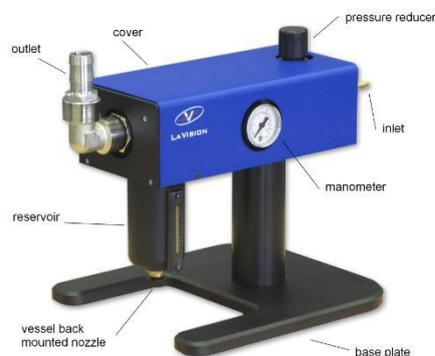
**Figure II.12 : Générateur de particules d'huile d'olive**
