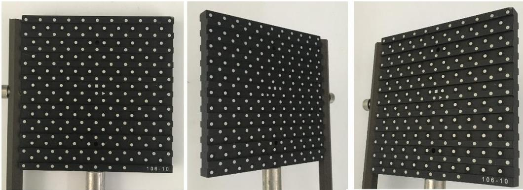
**Figure II.10 : 3-D mire de calibration**
