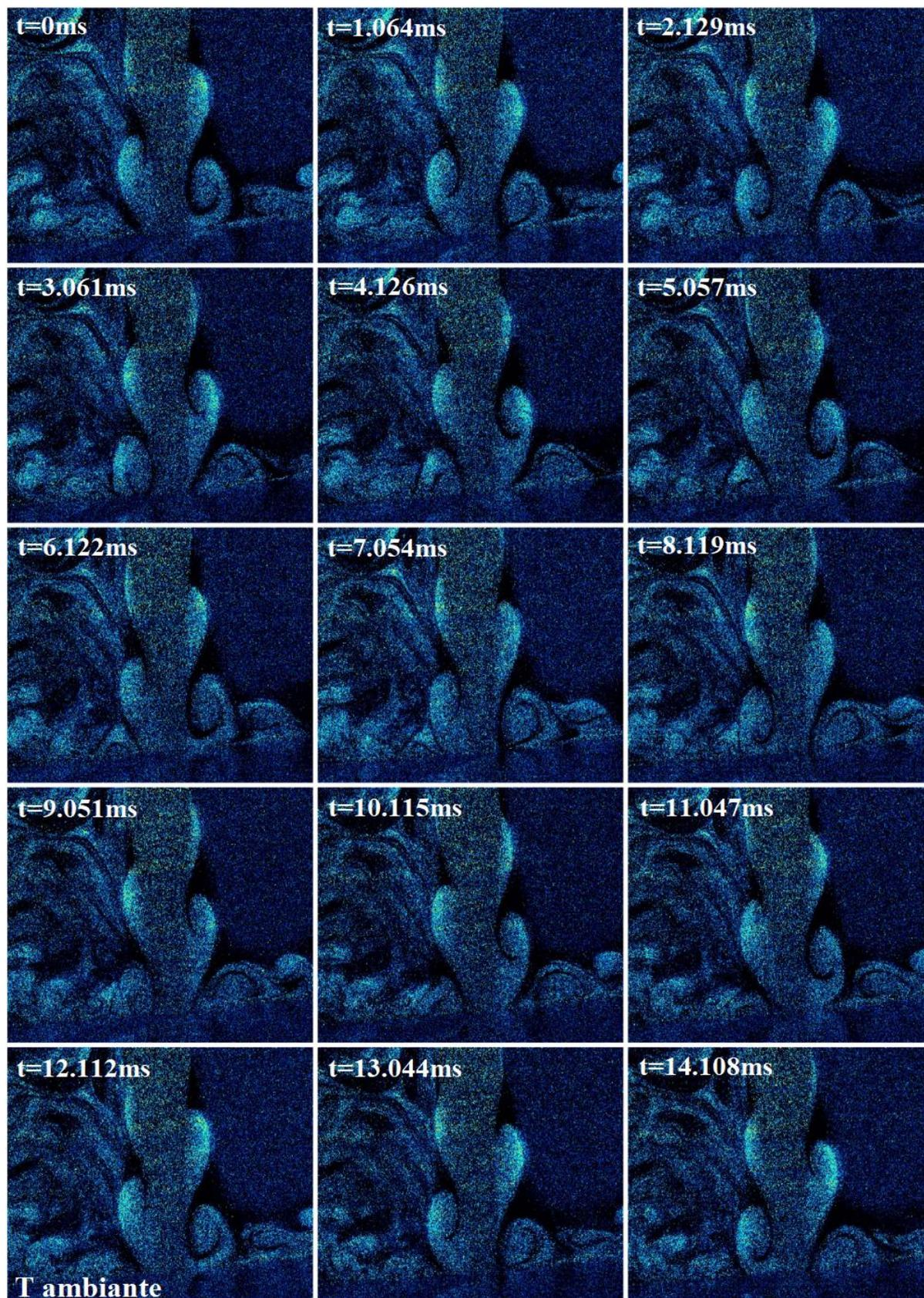
Figure V.21 : Suivi des structures tourbillons, image par image, à température ambiante de la plaque impactée par le jet
