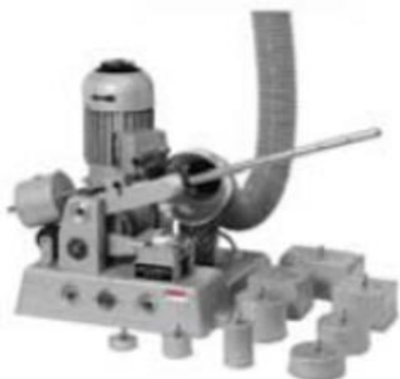
Figure 9 : Montage d'un test de sensibilité à la friction
