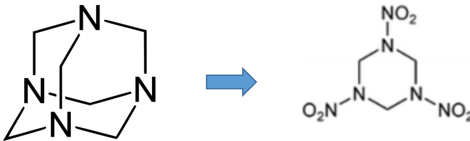
Figure 14 : Conversion de l'hexamine en hexogène.
