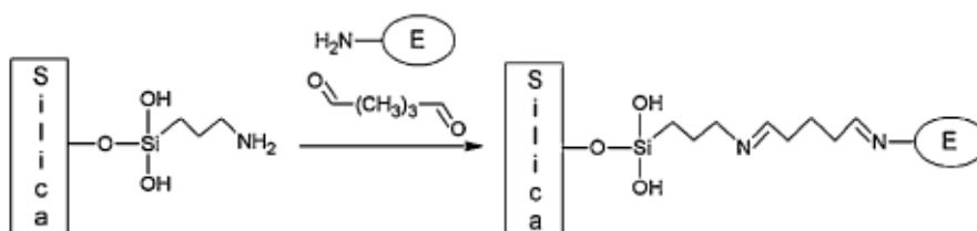
Figure 16. Réaction de l’immobilisation covalente des enzymes par le glutaraldéhyde sur une silice greffée aminopropyl 86
