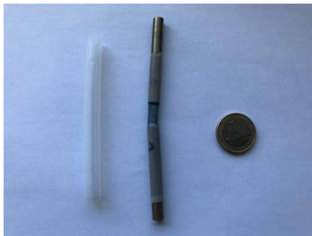
Figure 32. Photo du Teflon thermorétractable à gauche et du réacteur microfluidique composé de monolithe de carbone entouré par deux tubes en inox gainés par téflon thermorétractable.
