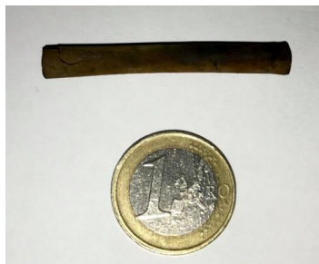
Figure 28. Photo du monolithe composite silice/hydrochar obtenu par imprégnation d'un monolithe de silice
