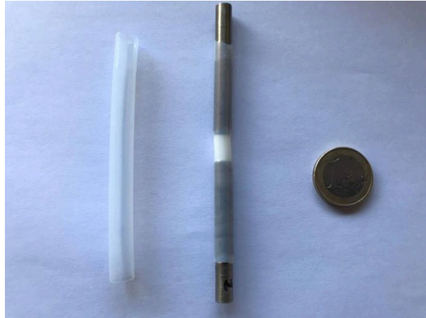
Figure 31. Photo du Teflon thermorétractable à gauche et du réacteur microfluidique composé de monolithe de Silice entouré par deux tubes en inox gainés par téflon thermorétractable.
